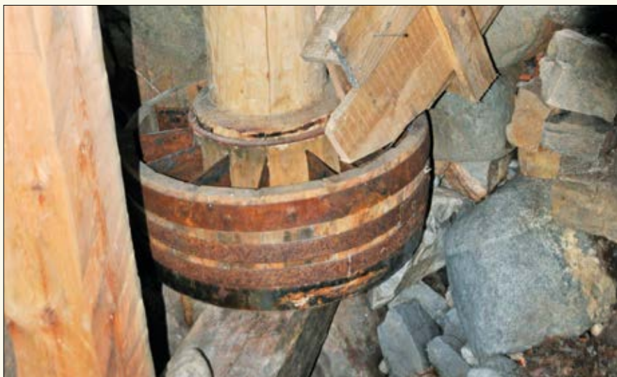
Selve «kvernkallen», turbinhjulet som drar møllesteinene, måtte bygges helt nytt. Men festet i fjellet er det originale.
